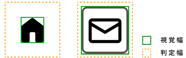
図 1: 視覚的な大きさと, システムが入力を受理する実際の領域が一致しないユーザインタフェース. デザイン維持のためにアイコンを小さくする (図左), 精度向上のために判定幅を拡大する (図右) などがある.
