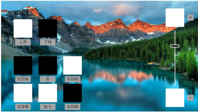
図 2 各 UI コンポーネントに対し、正方形のフリッカ刺激を用いた UI デザイン。従来のフリッカ刺激を用いた場合、図 1 よりもデザインの質が悪くなってしまふ。
