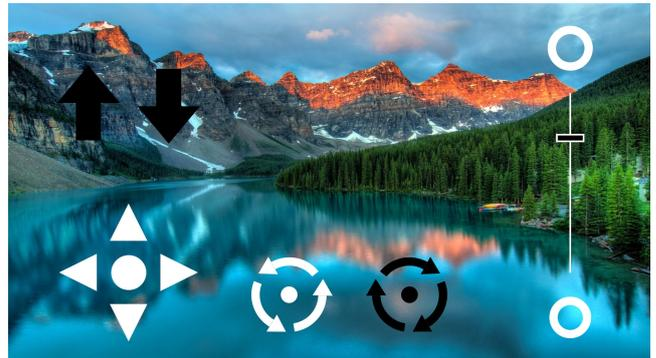
図 1 輝度変化による運動錯視を用いた SSVEP ベースの BCI 向け UI の提案イメージ。ドローン操縦用の UI を想定している。各 UI コンポーネントは並進運動や回転運動、拡大・縮小運動を無限に繰り返しているかのように知覚される。
