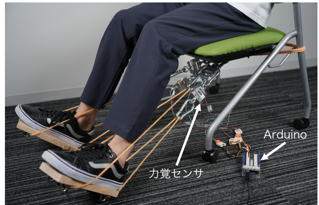
図 2: 足によるドローン操縦システム。両足の爪先側と踵側の紐にかかる張力を力覚センサで取得し、そのバランスによってドローンを操縦する。
