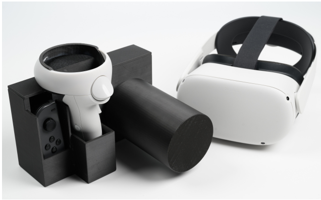
図 3: 手によるカメラ操作システム。カメラ型デバイスの向きによってドローンのカメラの向きを制御し、レンズを回転させることでズーム倍率を制御する。HMD (Meta Quest 2) にはドローンに搭載された全天球カメラの映像を映し出す。
