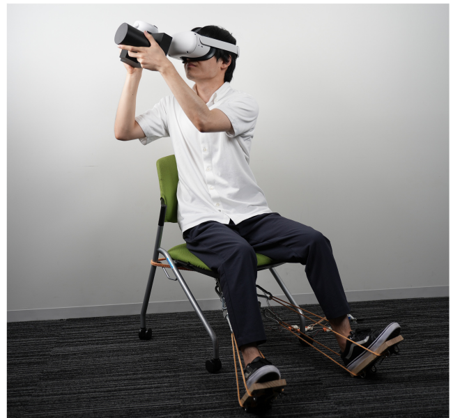
図1: 提案システムを使用している様子。足を伸ばす力によってドローンの操縦を行い、手に持ったカメラ型のデバイスによってカメラを操作する。本稿ではプロトタイプとして仮想空間内のドローンの制御に用いる。
