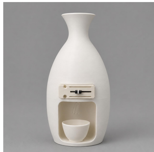
図1 S.A.K.E.の外観。徳利型の筐体前面に甘口・辛口印象を指定する物理スライダーを配置し、スライダー値に応じた味覚溶液を、下部に設置したおちょこ内の日本酒へ滴下する。
