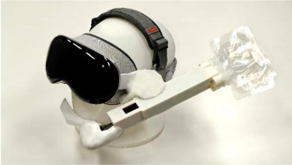
図1 メタバース空間でのテレポートを実現する TTTVR (HMDにTTTV4[12]を結合)
