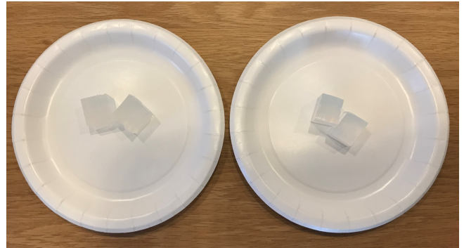
図 6 実験に用いた食塩水ゲルサンプル。0.56 %食塩水ゲルサンプル (左), および 0.80 %食塩水ゲルサンプル (右)。
